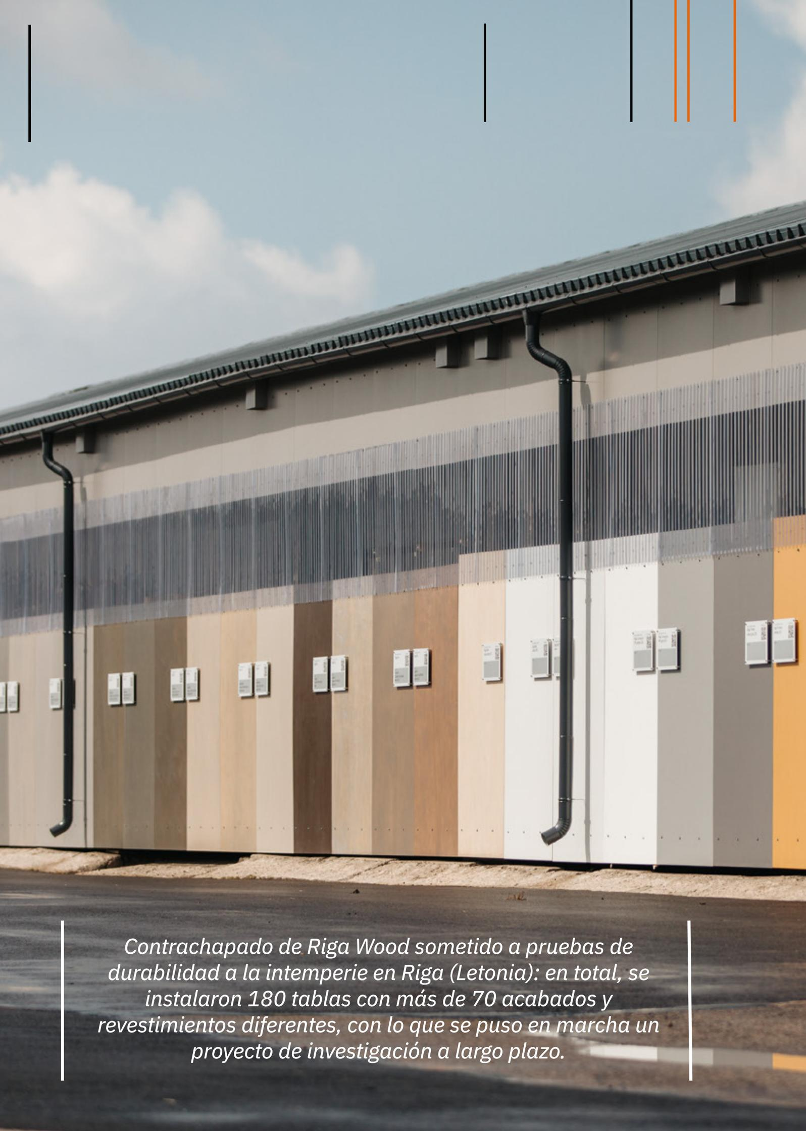
*Contrachapado de Riga Wood sometido a pruebas de durabilidad a la intemperie en Riga (Letonia): en total, se instalaron 180 tablas con más de 70 acabados y revestimientos diferentes, con lo que se puso en marcha un proyecto de investigación a largo plazo.*
